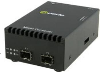
Perle **S-10GR-STS Medienkonverter** verbinden transparent 1G und 10G Ethernet Links über Multimode oder Single Mode LWL. Jeder Medienkonverter wird mit zwei steckbaren Transceiverports geliefert, die LWL zu LWL, Kupfer zu LWL oder Kupfer zu Kupfer Medienkonvertierung ermöglichen.
